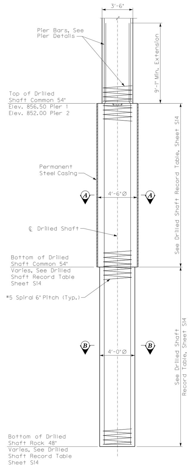
**TYPICAL DRILLED SHAFT**
